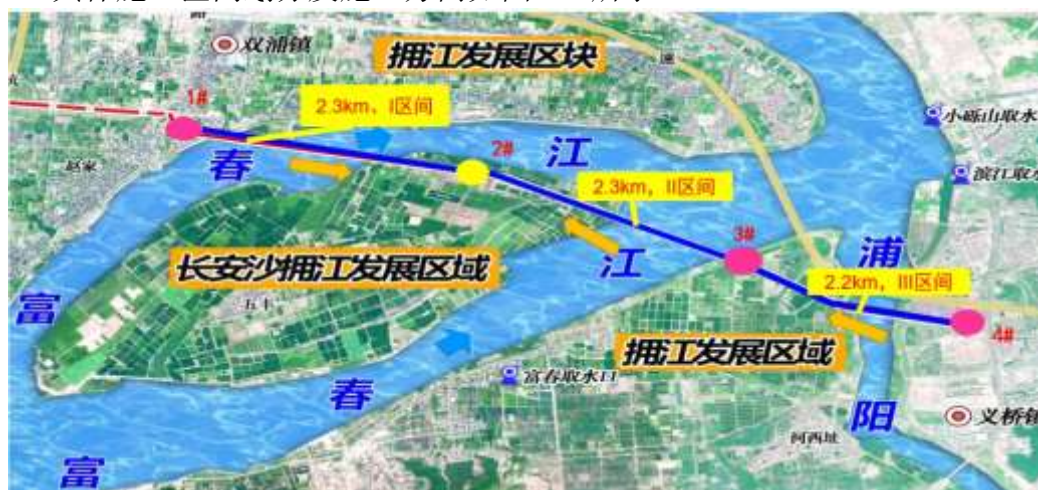
图 5-5 方案一盾构区间及盾构掘进方向
