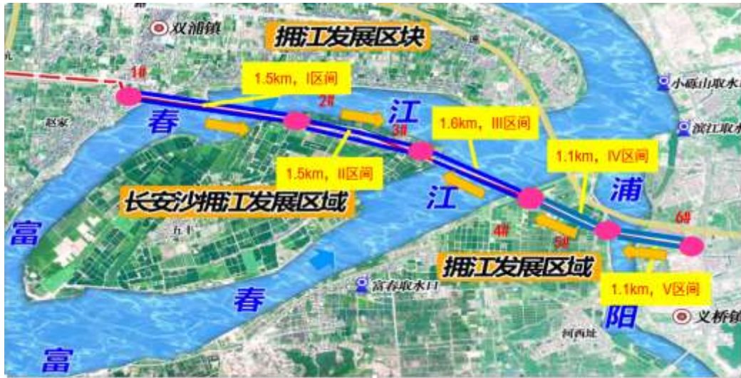
图 5-6 方案二顶管区间及掘进方向
